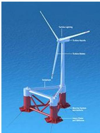
Figure 60 : Eolienne « flottante », ou « ancrée »
